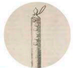
Figura 13 Termómetro de Galileo Galilei.
